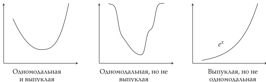
Рис. В.5. Выпуклость и одномодальность — это не одно и то же
