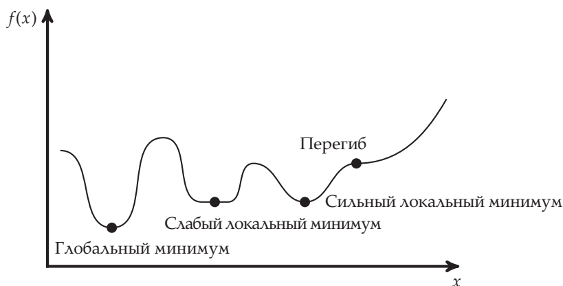
Рис. 1.6. Примеры критических точек одномерной функции, представляющих интерес для алгоритмов оптимизации (в которых производная равна нулю)
