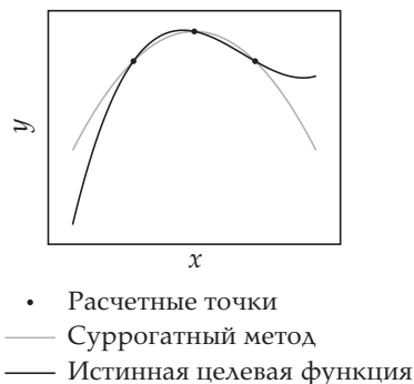
Рис. 14.1. Суррогатные модели приближают истинную целевую функцию. Модель настраивается по вычисленным расчетным точкам, но вдали от них отклоняется от истинных значений
