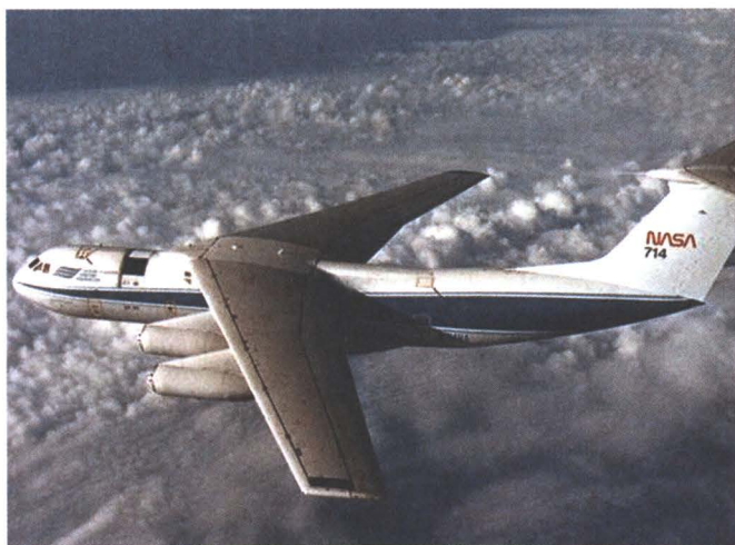
Воздушная обсерватория имени Койпера. В ее состав входил телескоп системы Кассегрена с диаметром зеркала 91,5 см, работавший в инфракрасном диапазоне. Кроме колец Урана, ученые обсерватории обнаружили атмосферу на Плутоне. В качестве платформы, несшей научное оборудование, служил специально переоборудованный транспортный самолет Lockheed C-141A Starlifter, позывной NASA 714. Обсерватория работала с 1974 по 1995 гг.
