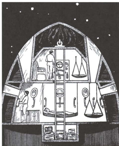
Примерное внутреннее устройство кают будущего корабля. Вверху каюта управления; над нею парашют в сложенном виде. Среднее отделение – пассажирская каюта. Нижнее помещение предназначено для хранения припасов.
