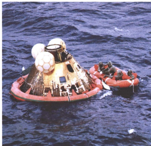
Командный модуль «Columbia» миссии «Apollo 11» после приводнения. Военно-морские аквалангисты подвели под спускаемый модуль надувной понтон и готовят модуль к открытию входного люка. Перед этим, модуль, приводнившийся днищем вверх, был поставлен в нормальное положение с помощью трех надувных шаров. 24 июля 1969 г.
