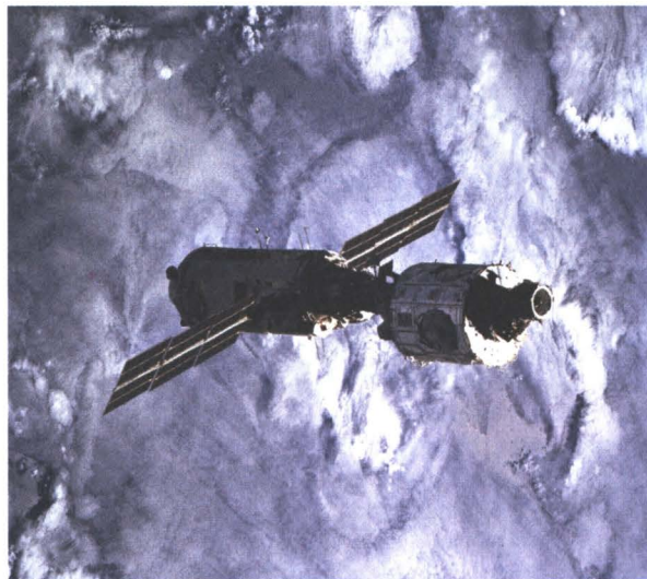
Начало строительства Международной космической станции. Модули «Заря» (слева) и «Юнити» (справа) уже состыкованы. 10 декабря 1998 г. на станцию прибыли первые обитатели: космонавт Сергей Крикалев и астронавт Роберт Кабана.
