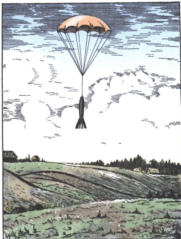
Испытание ракеты с жидким зарядом в Германии. Достигнув высшей точки подъема, ракета опускается вниз на парашюте. Такой опыт проделывали уже больше сотни раз.
