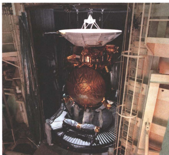
КА «Кассини-Гюйгенс» во время прохождения температурного и вибрационного теста. 1996г. Изображение НАСА.
