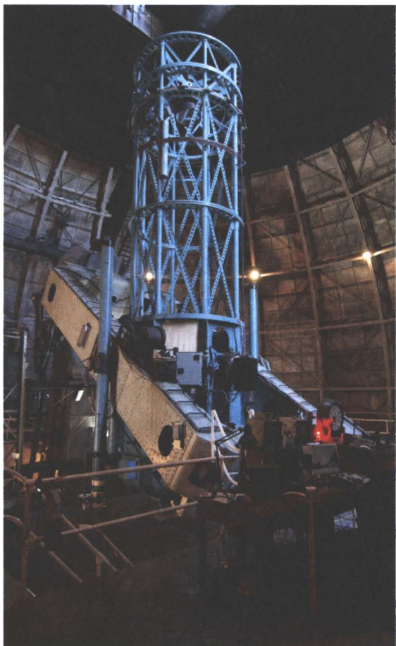
Рис. 87. Телескоп Джона Д. Хукера, давшего большую часть средств для постройки телескопа, в Обсерватории на горе Маунт-Вильсон в США. Диаметр зеркала этого инструмента – 250 см. в 1917 г. в момент начала работы телескопа он был самым большим в мире. Этим телескопом пользовался в своей работе выдающийся американский астроном Эдвин Хаббл, внесший решающий вклад в понимание структуры космоса.
