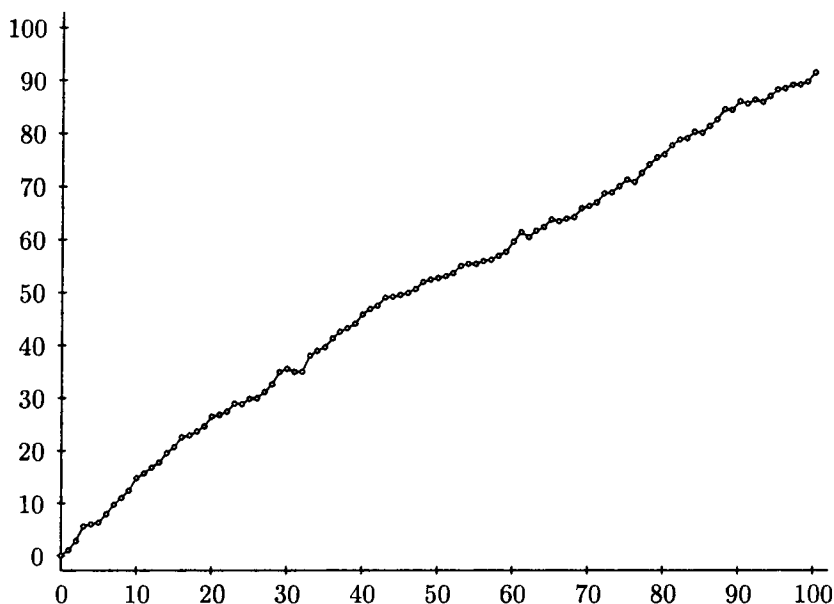
Рис. 21. График компьютерной реализации последовательности x = (x_n) , подчиняющейся ARIMA(0, 1, 1) -модели с \Delta x_n = \mu + b_1 \varepsilon_{n-1} + b_0 \varepsilon_n с параметрами \mu = 1, b_1 = 1, b_0 = 0.1; x_0 = 0
